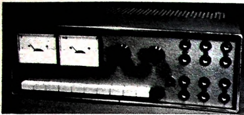
Bild 3. Außenansicht des Stromversorgungsgerätes im Flachgehäuse
